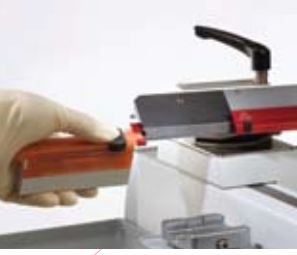
Insertion plus sûre de la lame jetable
