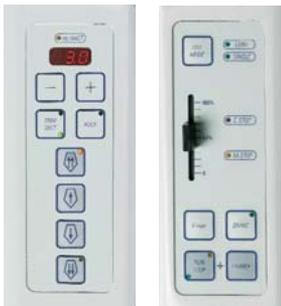
Komfortabel bei Nutzung durch mehrere Benutzer: die selbsterklärenden, jeweils nur mit einer Funktion belegten Funktionstasten und mühelos ablesbaren LED-Anzeigen tragen zur Vermeidung von Bedienungsfehlern bei, erleichtern das Kryoschneiden und machen das lästige Blättern in mehreren Menüs überflüssig. Dank der gut erreichbaren Bedienfelder in den Armauflagen ist es nicht erforderlich, zur Aktivierung oder Änderung von Einstellungen in die Kältekammer zu greifen.
