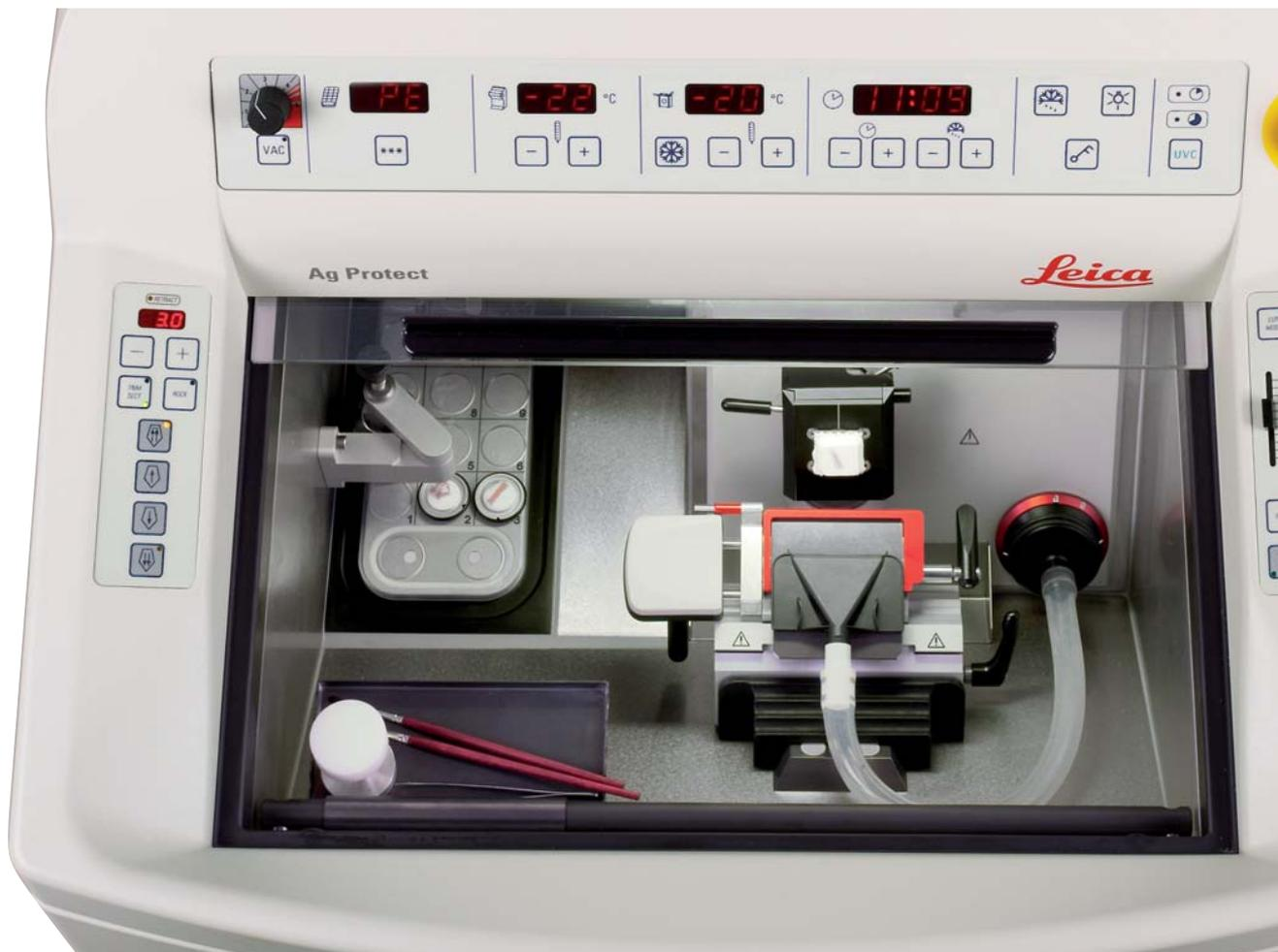
L'efficace inserimento del campione viene assicurato dal comando monoleva, che consente di ottenere la massima forza di serraggio indipendentemente dalla forza dell'operatore. Il raffreddamento a contatto diretto, ottenuto tramite la testa dell'oggetto a raffreddamento attivo (opzionale), agevola i rapidi cambi di temperatura del campione, per assicurare le migliori condizioni di sezionamento per tipi di campioni differenti.
