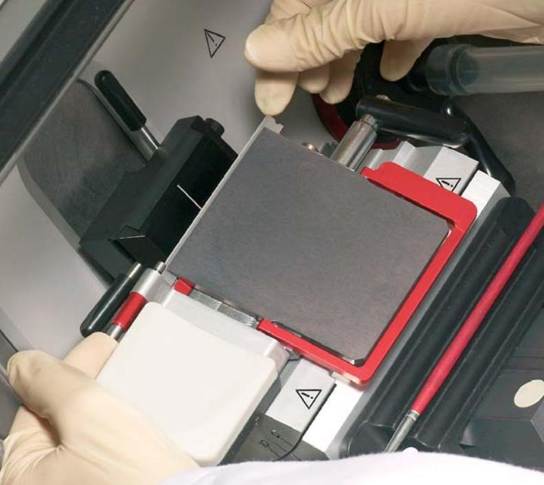
Il nuovo portalama monouso CE con proteggi-lama integrato e sistema di rimozione automatica della lama garantisce una maggiore sicurezza per gli operatori. Per gli utilizzatori che preferiscono utilizzare la tecnica a pennello durante il sezionamento, l'appoggiamano può sostituire la guida anti-roll.
