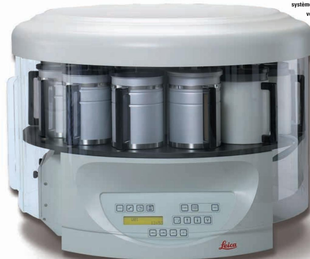
LeicaTP1020 avec fonction de traitement sous vide et système d'évacuation des vapeurs
