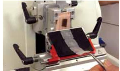
Questo nastro è stato tagliato con una corsa lenta e stabile da un blocchetto adeguatamente processato e ben raffreddato. Le sezioni rivelano una compressione minima, anche prima del galleggiamento.
