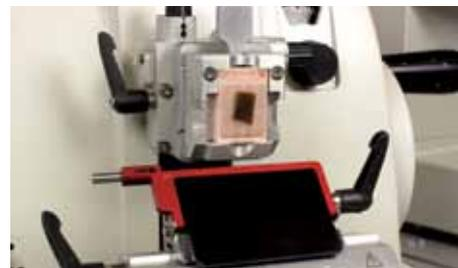
In questa figura la protezione di sicurezza rossa del microtomo Leica RM2235 è stata inserita in posizione e copre completamente il tagliente della lama.
