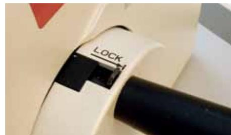
Qui il blocco del volano viene rappresentato con il volano in posizione ore 12 e il blocco inserito. Il blocco si inserisce soltanto in questa posizione in cima alla corsa di taglio.
