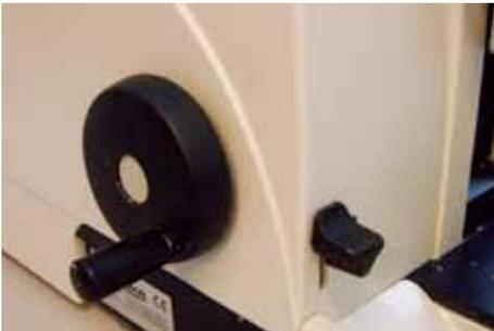
Durante la sgrossatura utilizzare con cautela il volano di avanzamento, così da evitare di tagliare accidentalmente sezioni spesse dalla superficie del campione e provocare danni.
