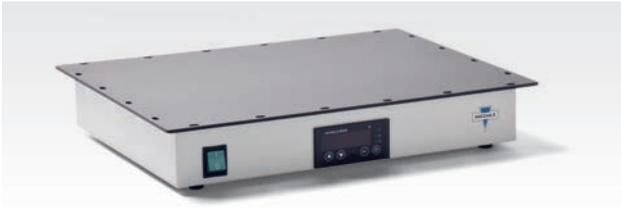
Wärmetische überwiegend für Kleintieroperationen und -versuche. Die exakte stufenlose Temperaturregelung bis + 50 °C, mit einer Konstanz von  $\pm 0,3$  °C durch genau arbeitende Elektronik, ist an der Digitalanzeige ablesbar. Hierbei erfolgt die genaue Soll-Temperaturvorwahl über einen Digitalvorwahlregler.
