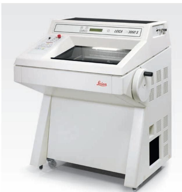
Bei Routine- und Forschungsanwendungen in der Biologie, Medizin und Industrie bietet Ihnen der Leica CM3050 S höchsten Komfort und ein vorbildliches Maß an Sicherheit. Seine Objektfeinorientierung gewährleistet eine optimale Schnittqualität und hohe Reproduzierbarkeit der Schnitte. Dadurch eignet er sich besonders gut für die Bearbeitung von Proben, wie sie zum Beispiel in der Neuroforschung anfallen.
