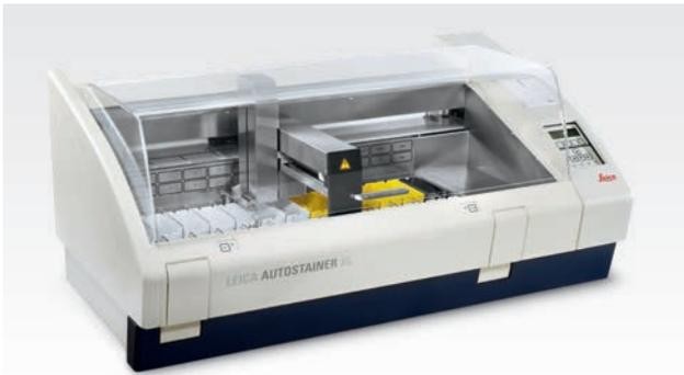
Der bewährte Leica Autostainer ST 5010 liefert reproduzierbare, konstante und hochwertige Färbeargebnisse und einen hohen Probendurchsatz. In Verbindung mit dem Glas-Eindeckautomaten Leica CV5030 bildet er eine Workstation, die keinen manuellen Transfer der Objektträgerhalter zwischen dem Färben und dem Eindecken mehr erfordert.
