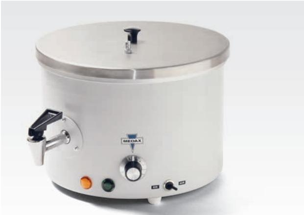
Dieser Paraffin-Spender hält etwa 2,5 kg Paraffin auf der gewünschten Temperatur. Über den beheizten, selbstschließenden, nicht tropfenden Hahn kann direkt in Formen oder Rahmen gegossen werden. Die stufenlose Temperaturregelung erfolgt thermostatisch bis +90 °C. Das Gerät wird mit Vakuumdeckel geliefert. Hierdurch besteht die Möglichkeit, an der Schlaucholive am Deckel eine Vakuumpumpe anzuschließen.
