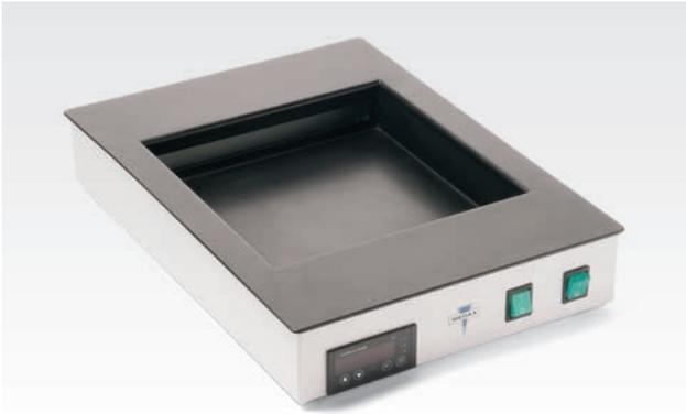
Spezialbäder zum Strecken und Trocknen geschnittener Gewebeproben für die Verwendung in pathologischen, histologischen, chemischen, bakteriologischen Laboratorien. Optimale Beobachtung und Manipulation der Präparate durch mattschwarze Oberfläche des Behälters. Exakte stufenlose elektronische Temperaturregelung bis +80 °C bzw. +70 °C, mit einer Konstanz von  $\pm 1$  °C. Ist-Temperatur wird permanent angezeigt. Soll-Temperatur in 1° Steps voreinstellbar
