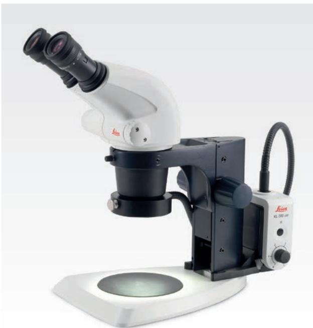
Das Leica S4 E funktioniert nach dem Greenough-Prinzip. Der 4.8:1-Zoom bietet ein großes Sehfeld von bis zu 36,5 mm – ideal für Montagen, Inspektionen und Reparaturen (z.B. von Leiterplatten).
