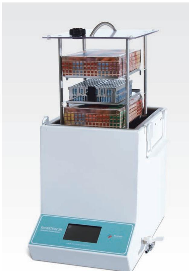
Temperatur und Zeit werden von der FixSTATION 3R H während der Fixierung überwacht. Die Temperatur ist einstellbar von Raumtemperatur bis 50°C und die Zeit von 1 Minute bis zu 99 Stunden. Neben den Milestone Racks können alle gängigen Standardracks verwendet werden. Bietet Platz für bis zu 3 Racks.
