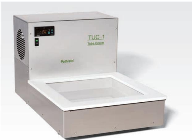
Die Schnellkühlwanne TUC-1 arbeitet mit Wand und Bodenkühlung. Die Temperatur ist regelbar, bis zu  $-40^{\circ}\text{C}$ . Da die Kälte nicht wie bei gewöhnlichen Kühlplatten an den Seiten «herunterfallen» kann, ist eine konstante, leistungsstarke Kühlung sehr energiebewusst möglich. Und dies fast ohne Vereisungen. Auch in XXL erhältlich.
