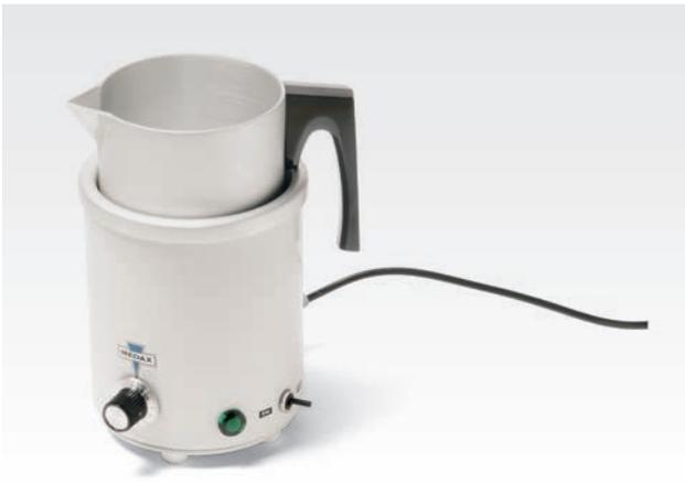
Das Gerät dient zum Erwärmen und Gießen von Paraffin für Gewebereinbettungen u.ä. für histologische, bakteriologische und chemische Laboratorien. Mit diesem Gerät ist ein bequemes und leichtes Arbeiten möglich, da ständig gießbereites Paraffin am Arbeitsplatz griffbereit ist. Die stufenlose Temperaturregelung erfolgt thermostatisch bis + 90 °C.
