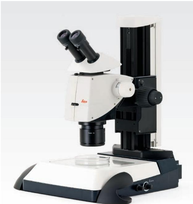
Das modulare Leica M165 C ist ein apochromatisch korrigiertes Stereomikroskop mit 16.5:1 Zoom und einer Auflösung von maximal 906 lp/mm (2× planapochromatisches Objektiv). Der Anwender kann auch kleinste Details der Probe erkennen und eine 3D-Analyse durchführen, ohne dabei die Instrumente zu wechseln.
