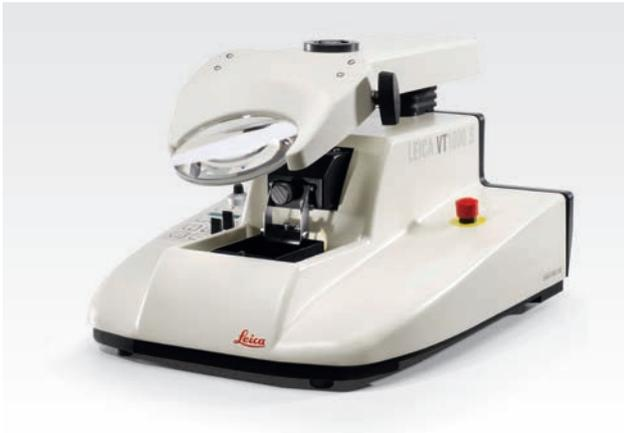
Das Leica VT1000 S ist ein Mikrotom mit vibrierendem Messer für hohe Schneideanforderungen in der Neurophysiologie, Neuropathologie und der experimentellen Pathologie. Beim Schneiden von fixiertem Gewebe für gezielte neuropathologische Untersuchungen überzeugt Sie das Leica VT1000 S durch seine herausragenden Schneideleistungen.
