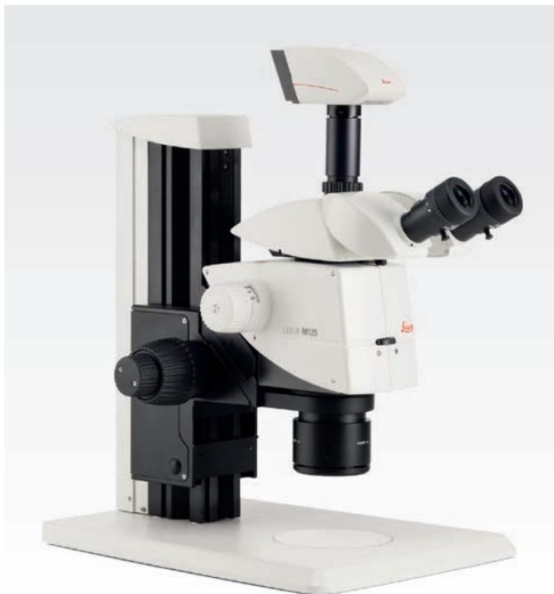
Das modulare Stereomikroskop Leica M125 bietet einen voll apochromatisch korrigierten 12,5:1-Zoom. Dieser große Spielraum ermöglicht sowohl die Übersicht über eine Probe als auch die Beobachtung feinsten Strukturen bis zu einer Auflösung von 1,15 µm – ideale Voraussetzungen für die Analyse von Kunststoffen, die Kontrolle von Leiterplatten oder die Vorsortierung mechanischer Komponenten.
