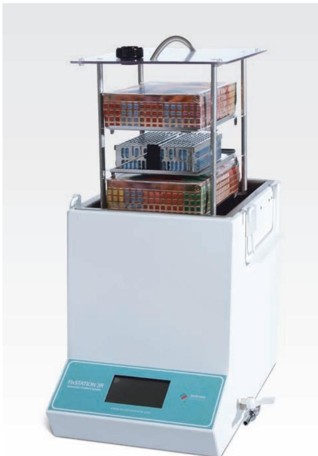
La température et la durée sont contrôlées par FixSTATION 3R-H pendant la fixation. La température peut être réglée de la température ambiante jusqu'à 50 °C et la durée de 1 minute à 99 heures. En plus des racks Milestone, tous les racks standard courants peuvent être utilisés. Peut contenir jusqu'à 3 racks.
