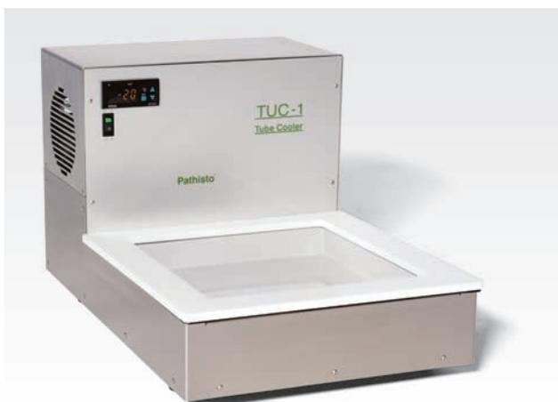
La cuve de réfrigération rapide TUC-1 assure un refroidissement au niveau des parois et du socle. La température est réglable jusqu'à  $-40\text{ }^{\circ}\text{C}$ . Comme le froid ne peut pas «s'échapper» sur les côtés comme avec les plaques de refroidissement habituelles, un refroidissement puissant, constant et à très faible consommation d'énergie est possible. Et cela, presque sans givrage. Egalement disponible en taille XXL.
