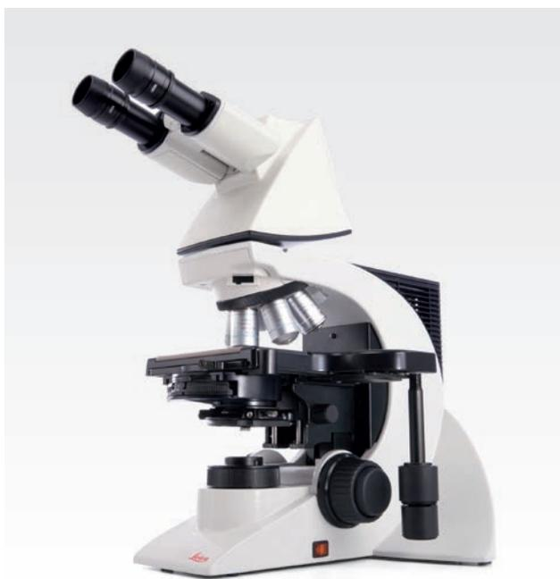
Le Leica DM2000 est disponible dans deux versions, avec éclairage halogène lumineux ou éclairage LED longue durée
