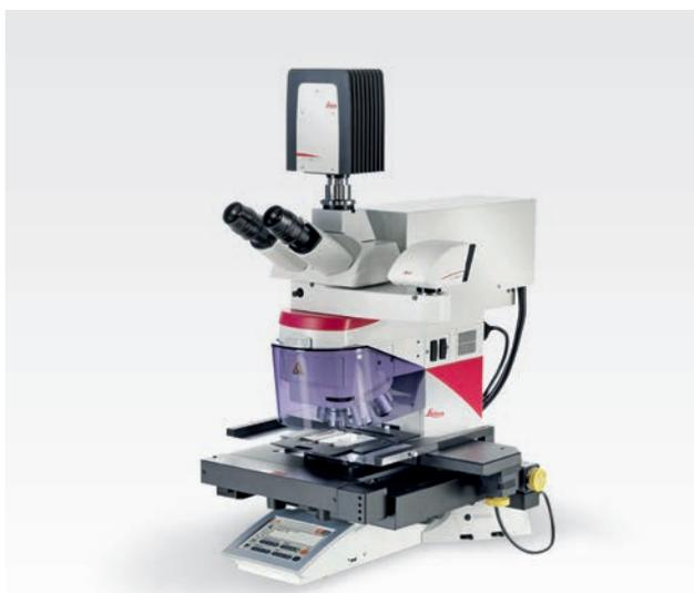
Nous déplaçons le laser, pas l'échantillon. Et nous utilisons la gravité pour collecter les échantillons disséqués. C'est pourquoi, grâce à nos systèmes LMD, les échantillons disséqués sont parfaitement coupés, non contaminés et prêts pour l'analyse.
