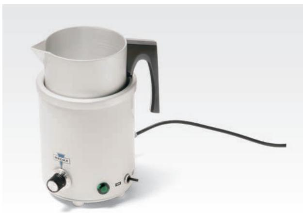
L'appareil sert à chauffer et verser la paraffine pour l'enrobage des tissus, entre autres pour les laboratoires histologiques, bactériologiques et chimique. Cet appareil facilite le travail car il permet de toujours avoir à disposition sur le poste de travail de la paraffine prête à être coulée. La température est réglée en continu de manière thermostatique jusqu'à 90 °C.
