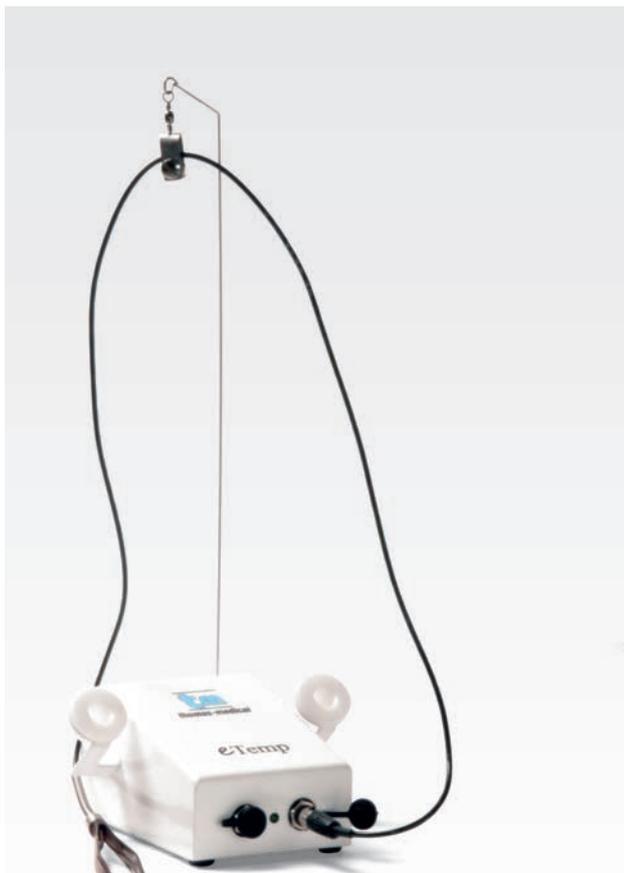
Le système électrique chauffé de pincettes a été conçu pour la préparation d'échantillons histologiques et histopathologiques. Le eTemp fonctionne avec une très basse tension et des éléments de chauffage à température régulée qui permettent de maintenir les extrémités de la pincette à une température optimale pour le traitement de préparations incluses dans de la paraffine histologique. Le boîtier est en acier inoxydable soudé, avec revêtement par poudre.
