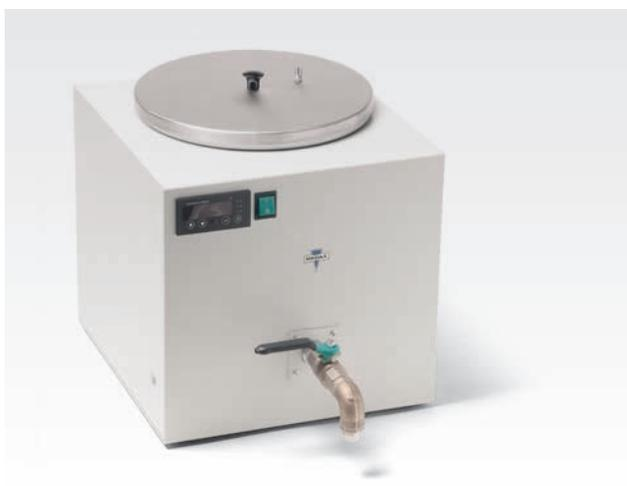
Les distributeurs de paraffine maintiennent la paraffine à la température souhaitée. Ils sont employés partout où la paraffine est utilisée en grandes quantités et où un chauffage et un écoulement pratiques de la paraffine sont souhaités. Température de consigne: jusqu'à +90 °C préréglable par paliers d'1 °C, indiquée sur un affichage numérique. Réglage électronique de la température avec précision de réglage d'1%. La température réelle est indiquée en continu sur l'affichage numérique.
