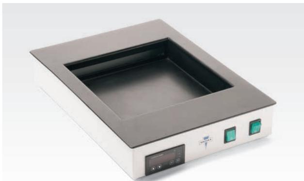
Bains spéciaux pour l'étalage et le séchage d'échantillons de tissu coupés, pour un usage en laboratoire pathologique, histologique, chimique ou bactériologique. Observation et manipulation optimales des préparations grâce à la surface noire mate du récipient. Réglage électronique précis et continu de la température jusqu'à + 80 °C ou + 70 °C, avec une constance de 1 °C. La température réelle est affichée en continu. Température de consigne pré-réglable par paliers d'1°
