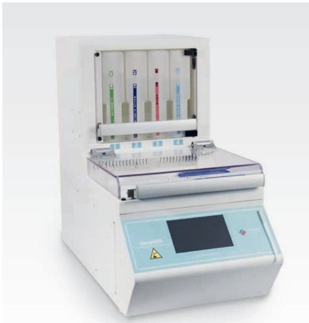
DecalMATE exécute de manière entièrement automatique la décalcification et la fixation de moelle osseuse. Des protocoles optimisés garantissent un processus standardisé.
