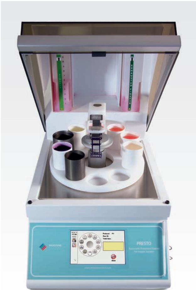
PRESTO traite, colore (H&E) et déshydrate en 4 minutes les coupes congelées. Le protocole automatique assure une standardisation et accroît la qualité lors des coupes rapides. Les protocoles peuvent être adaptés par l'utilisateur, 7 cuvettes à coloration pouvant être sélectionnées. Le logiciel convivial et intuitif simplifie la commande, et le système de ventilation intégré accroît la sécurité du travail. Associé au PrestoCHILL, PRESTO garantit des résultats optimaux en un temps réduit.
