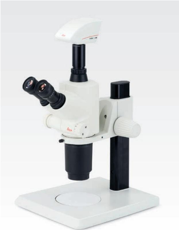
Le stéréomicroscope Greenough, Leica S8 APO avec un zoom apochromatique de 8:1 et une distance de travail de 75 mm facilite l'accès à l'échantillon, même avec un fort grossissement jusqu'à 80x qui est idéal pour les applications de contrôle de la qualité, de tri de cellules et de micro injection.
