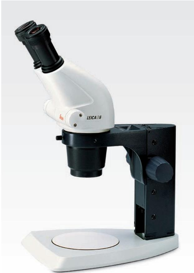
Le Leica S6 avec un système optique Greenough, un zoom de 6,3:1 et un angle de tube oculaire de 60° fournit un large champ de vision jusqu'à 36,5 mm et une grande profondeur de champ.
