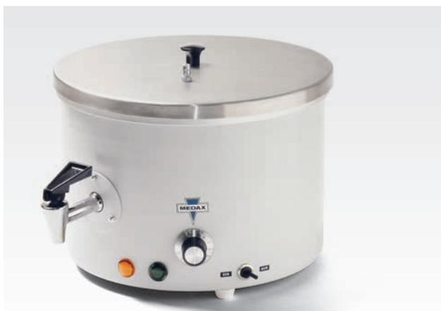
Ce distributeur de paraffine maintient environ 2,5 kg de paraffine à la température souhaitée. Le robinet chauffé, à fermeture automatique et anti-goutte permet de verser la paraffine directement dans les moules ou cadres. La température est réglée en continu de manière thermostatique jusqu'à +90 °C. L'appareil est livré avec couvercle de vide. Une pompe à vide peut être raccordée au niveau de l'olive de tuyau du couvercle.
